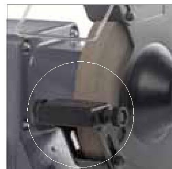
Pevná podpora obrobku upevněná na obou stranách
