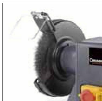
Ocelový kartáč lze umístit pod kryt brusného kotouče
