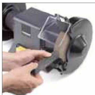
Orovňávací kámen pro zdrsňení, opravu a čištění brusného kotouče
