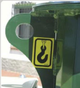
Ganci di sollevamento Lifting hook Crochets d'élévation Enganches para el levantamiento Aushebelhaken Opfit haken
