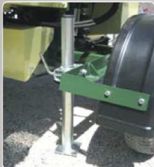
Piedini di appoggio per fase di lavoro Support for working session Pieds d'appui pour la position de travail Pies de apoyo para fase de trabajo Standbein für den Arbeitsabschnitt Steunvoet voor de werkstand
