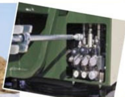
Comandi idraulici per alimentazione materiale, per funzionamento tappeto di scarico e per apertura e chiusura del tappeto di scarico.
