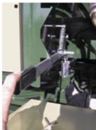
Leva di sgancio per rotazione ralla. Release lever for the pivot rotation. Levie d'embaroyage de la machine. Palanca de desenganche para rotación chumocera. Ausrüstungshebel zur Drehung des Rings. Helfboom voor loskoppelen draaikrans.
