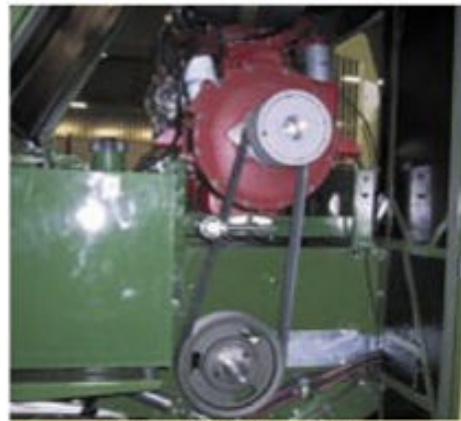
Trasmisione con frizione per versione diesel Transmission with clutch for diesel version Transmission avec embrayage pour version diesel Transmission con embrague para versión diesel Getriebe mit Kupplung für die Diesel Ausführung Overbrenging met koppeling voor de diesel versie
