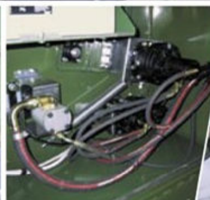
Hydraulische bedieningen voor de materiaalvoer, voor de werking van de afvoerband en voor het openen en weer sluiten van de afvoerband.
