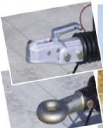
Occhio di traino a pallino o ad anello. Ball or ring towing eye. Tête d'attelage à boule ou à anneau. Ojo del remolque de bolita ou de anillo. Kugel oder ringförmige anhängeroese. Trekstang voor - belkoppeling of ring.
